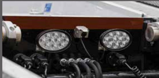
Zusätzlicher LED Arbeitsscheinwerfer
