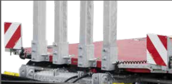
Rungentasche und Einsteckungen vorne stirnseitig angebracht, Warntafeln
