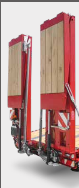
Geteilte Rampen mit Koppelstange
