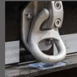
In den Außenrahmen integrierter Zurrpunkt bis 6 000 kg Zugkraft
