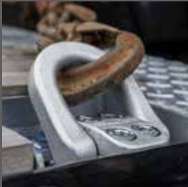
versenkter Zurrpunkt bis 10 000 kg Zugkraft
